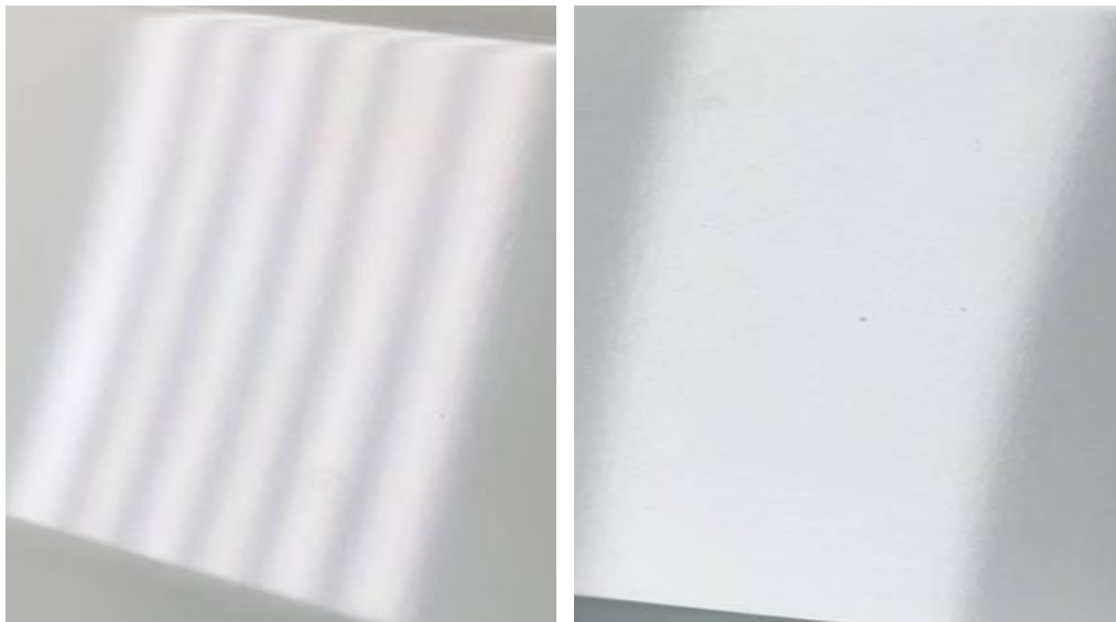
图 1： 左：栅格式条纹光 右：透射式条纹光 磨砂表面的缺陷成像需要测试验证
