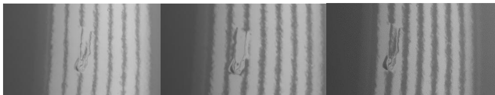
图七： 不同占空比方波条纹光占空比的图像特征对比
